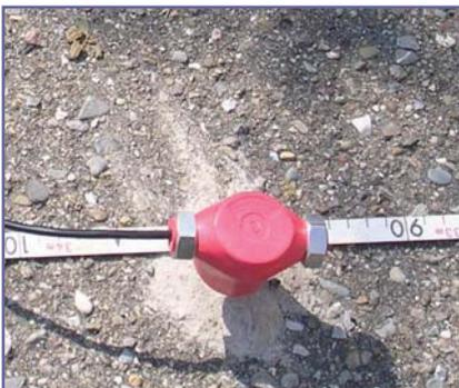
I geofoni verticali del tipo elettromagnetico a bobina mobile, con frequenza caratteristica di 4,5 Hz, consentono di convertire in segnali elettrici gli spostamenti che si verificano nel terreno.
